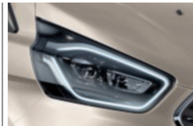
Bi-Xenon-Scheinwerfer mit statischem Kurvenlicht, LED-Tagfahrlicht und Nebelscheinwerfern
